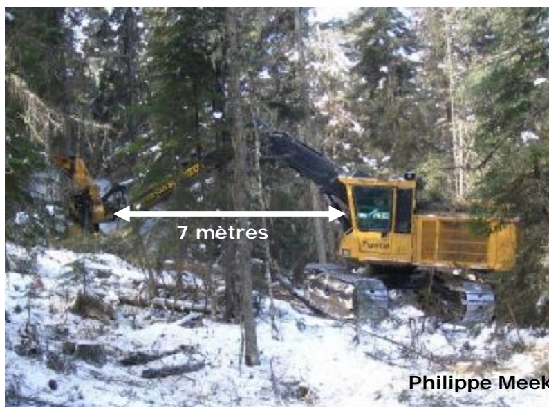
Figure 7 : La largeur de la bande de prélèvement est déterminée en fonction de la portée du bras de l'abatteuse-groupeuse 870, qui atteint environ 7 m. Exemple, si le bras atteint 5 m, la largeur de la bande prélèvement sera de 5 m.
