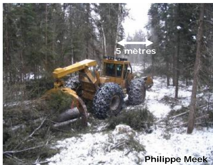
Figure 2 : Débardeur à grappin Tigercat 630 se déplaçant à l'intérieur du sentier de débardage et des portes de 5 m de largeur.
