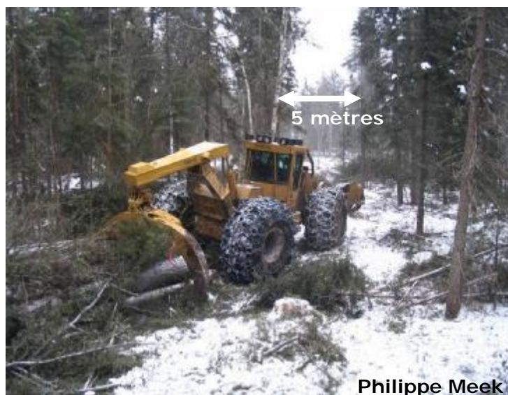
Figure 6 : Débardeur à grappin Tigercat 630 se déplaçant à l'intérieur du sentier de débardage et des portes de 5 m de largeur.
